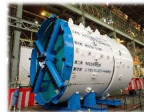
貯留管整備に使用したシールドマシン
