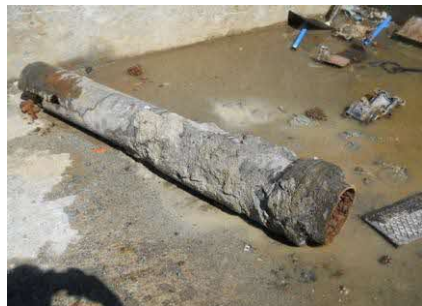
漏水により撤去した水道管
