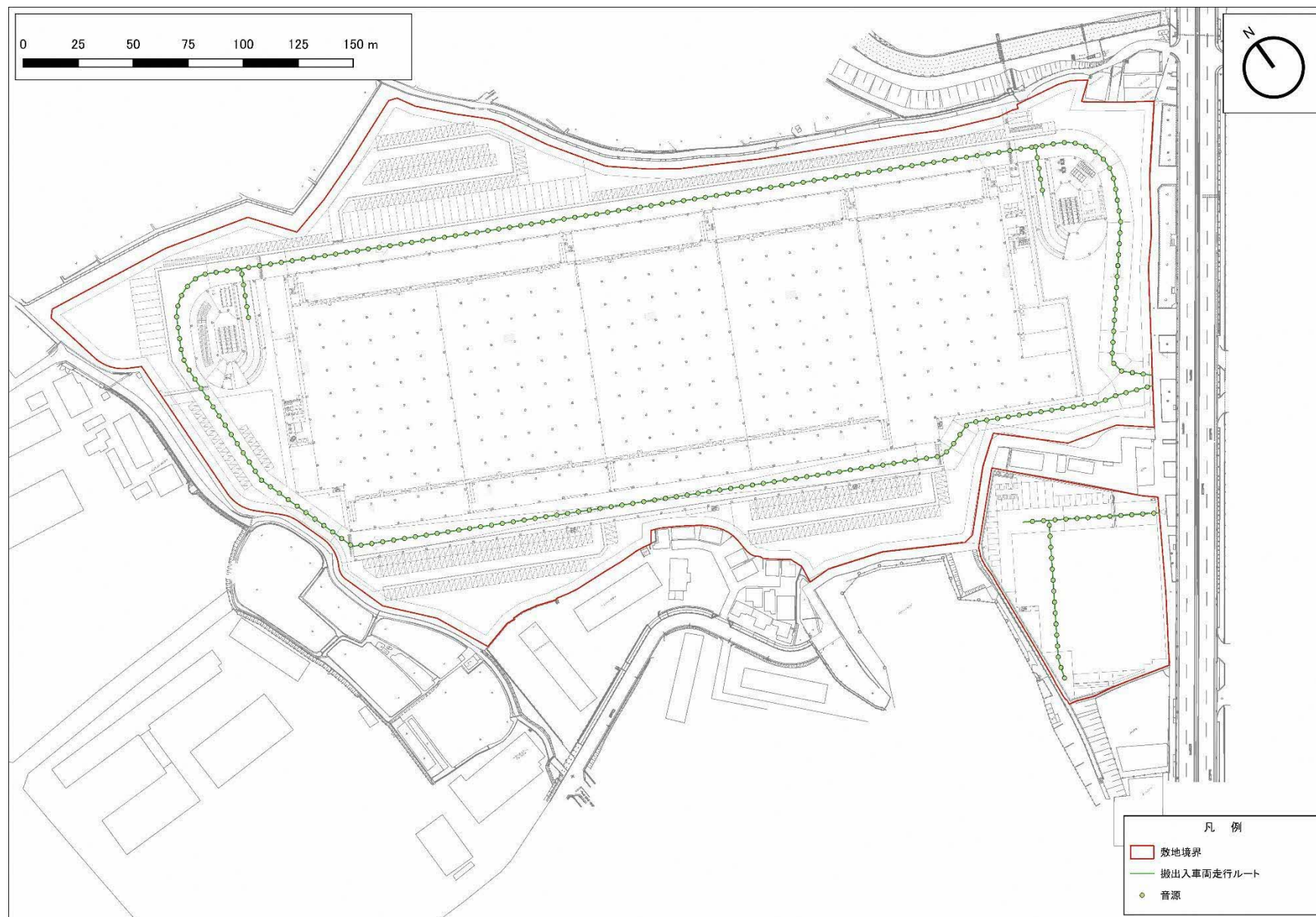
図 3.3-18 施設騒音走行ルート（1 階、搬出入車両）
