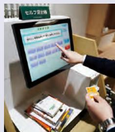
◀市駅前図書館に設置しているICタグ専用の自動貸出機。簡単な操作でスムーズに借りることができます
