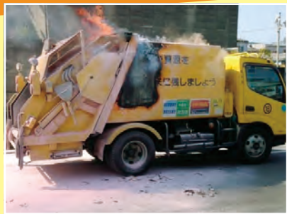
▲ごみ収集車で発生した火災の様子と 燃えたリチウムイオン電池など。 約1000万円の収集車が使用不能に。
