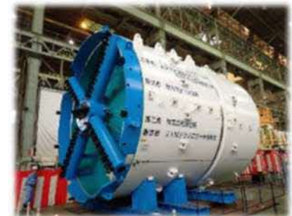
貯留管整備に使用したシールドマシン
