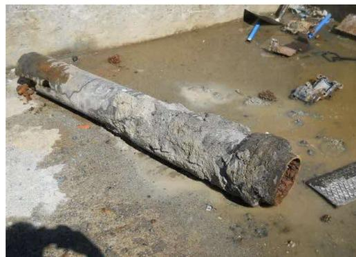
漏水により撤去した水道管
