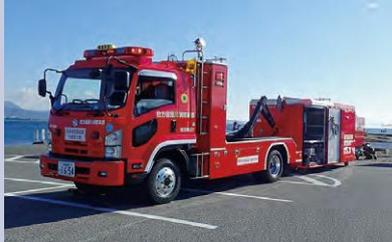
多様な場面に対応する特殊車両が多数。写真車両は断水時でも淀川などを利用し大量放水が可能。
