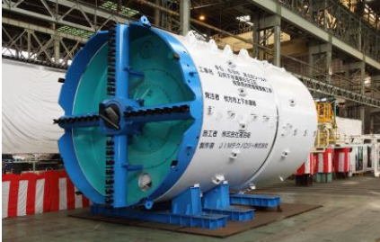
＜シールドマシン（楠葉雨水貯留管）＞
