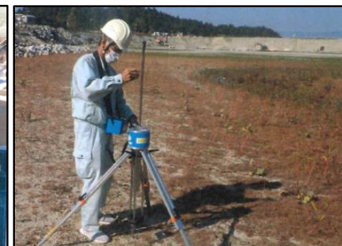
支持力測定器による試験
