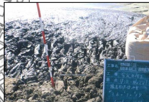
想定より著しく緩い池の堆積泥土
