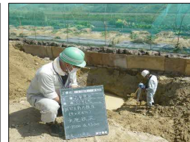
キャスポル（簡易支持力測定器）にて地盤支持力を測定し、セメント系固化材の添加量を算出
