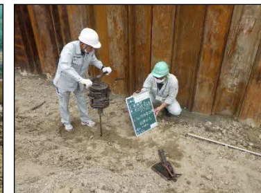
スクリーウエイト試験にて土層の構成を判定し、改良厚を算出
