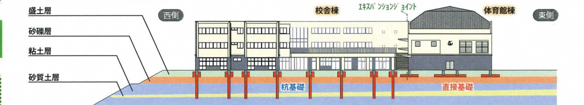
【図3-7 想定される地盤と基礎形式の考え方の概念図】
