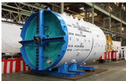
＜シールドマシン（楠葉雨水貯留管）＞
