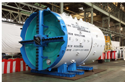
<シールドマシン（楠葉雨水貯留管）>
