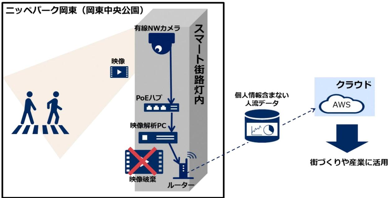
機器同士が実線につながっている部分がLAN ケーブル接続、点線が無線接続になります。
