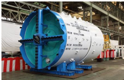
＜シールドマシン（楠葉雨水貯留管）＞
