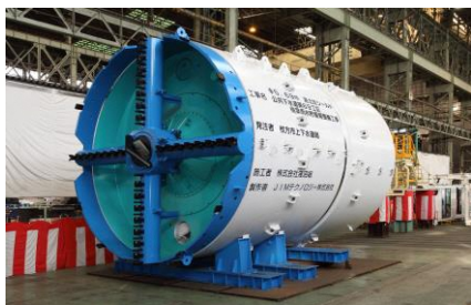
<シールドマシン（楠葉雨水貯留管）>
