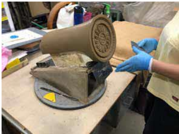
軒瓦は型枠でプレスした後、人の手で調整しています。やはり根気のいる作業です。
