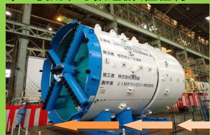
工事で使用する掘進機(直径約5m)
