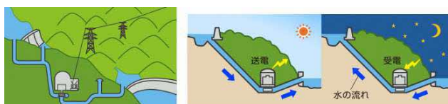
揚水発電のしくみ図
