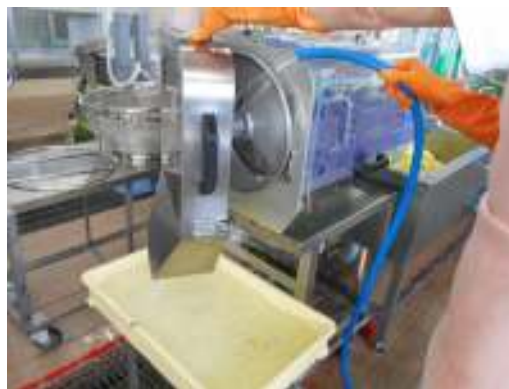
ドライ運用（洗浄水をトレーで受け、床にこぼさない）
