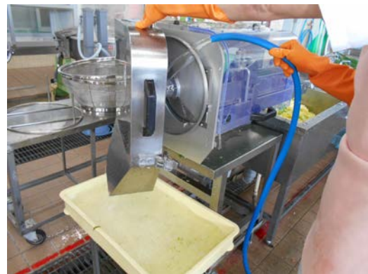
ドライ運用（洗浄水をトレーで受け、床にこぼさない）
