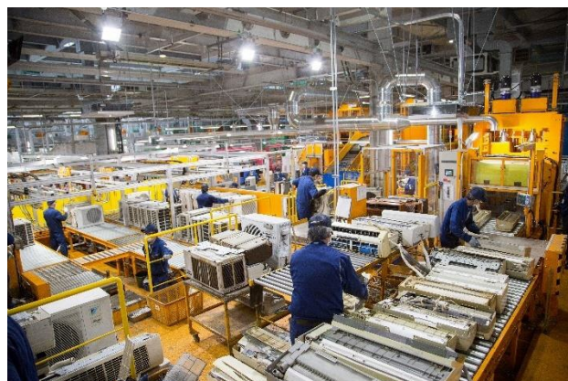
【エアコン解体ライン】
