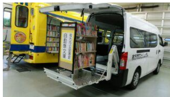
リフト付き運搬車(平成27(2015)年12月)
