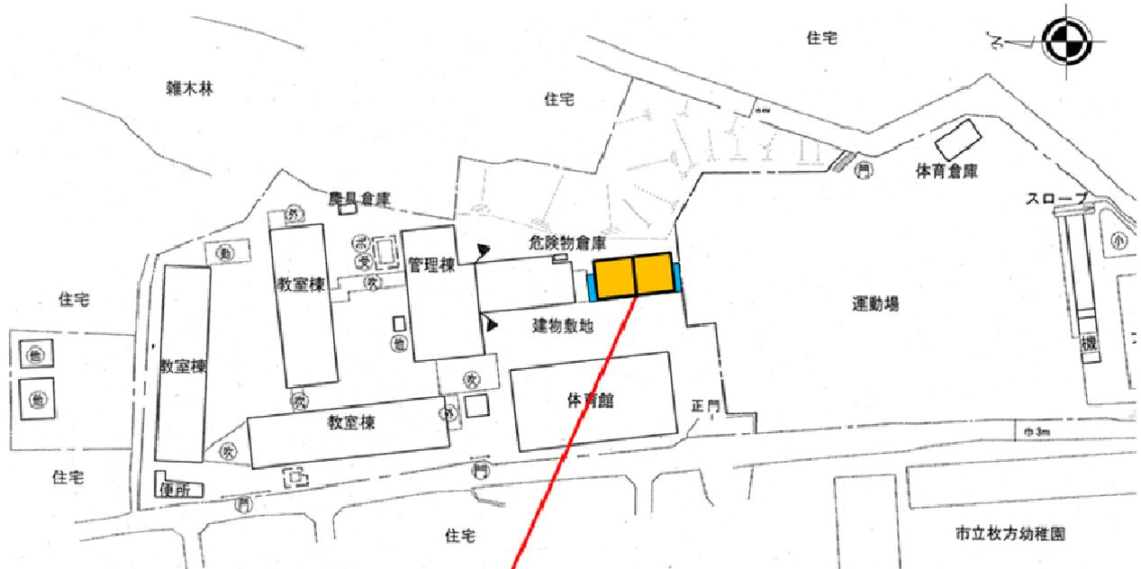
管理棟南側に軽量鉄骨構造校舎（2階建4教室）を増築
