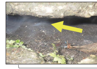
側溝の亀裂やマンホール蓋の穴から煙が上がっている様子 （雨天時浸入水として污水管内に入ってくるおそれがある箇所）
