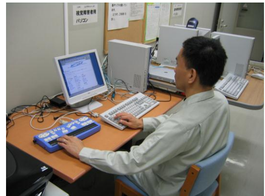
パソコンの画面の情報をピンで点字に表し、指でなぞって読める
